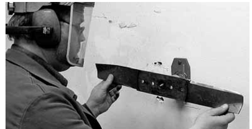
Bild 5: Mit diesem Gerät wird geprüft, ob das Messer nach dem Schleifen keine Unwucht hat.
