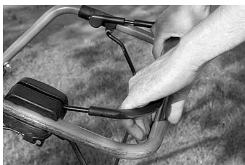
Bild 2: Schalteinrichtungen wie diese Tippschaltung müssen einwandfrei funktionieren.
