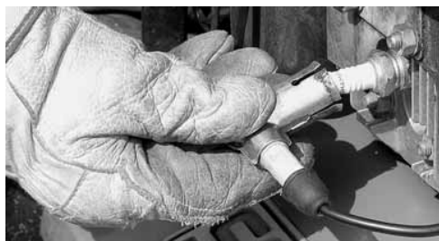
Bild 4: Beim Verlassen und Warten des Mähers muss der Zündstecker (bzw. das Elektrokabel bei elektrischem Antrieb) herausgenommen werden.
